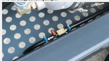
Кран слива отстоя из топливного бака
