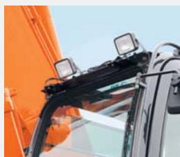
Дополнительные передние фонари освещения на крыше кабины
