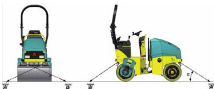
4 проушины для безопасного крепления на прицепе /грузовике
